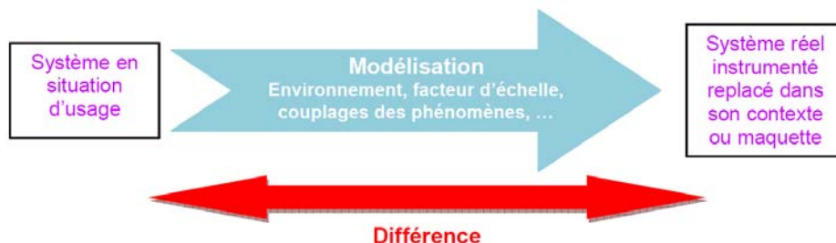
Figure 6 – Mise en évidence d'une différence entre les performances mesurées sur le système en situation d'usage et sur la maquette
